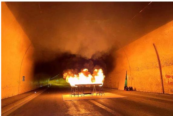
Nicht alltägliche Brandsicherheitswachen wurden im Juni und Juli absolviert: In den Tunnel der A10 wurden zum Test der Tunnellüftung mehrere Brandversuche durchgeführt. Jeder Versuch stellte die Brandlast eines ganzen PKWs dar.
